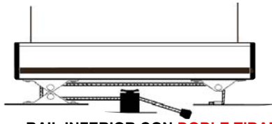
RAIL INFERIOR CON DOBLE TIRADOR MUELLE DE TENSION CONSTANTE IDEAL PARA VENTANAS ABATIBLES
